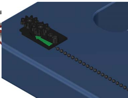
Inserire la catena nel rocchetto superiore
