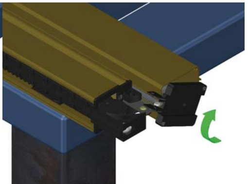
Posizionare la testata inferiore all'interno della molla e procedere alla carica
