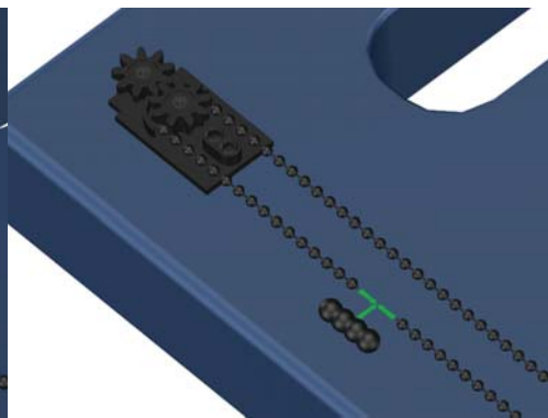
unire la catena con la giunzione
